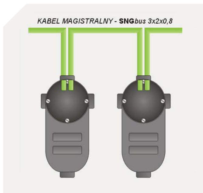
Rys. Schemat prowadzenia magistrali SNGbus 3x2x0,8, punkt-punkt
